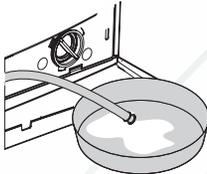
Выньте шланг аварийного слива из отсека. Поместите под конец шланга вместительную емкость. Выньте пробку на конце шланга и слейте воду. Когда емкость наполнится, закройте шланг пробкой. Вылейте воду из емкости и повторите описанную выше процедуру, пока вода не будет
