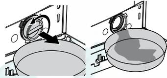
Поставьте перед фильтром вместительную емкость для слива воды. Понемногу поворачивайте фильтр насоса и уложите его на место. Поверните фильтр насоса и выньте его. Слив воды в моделях, не оснащенных шлангом аварийного слива:
