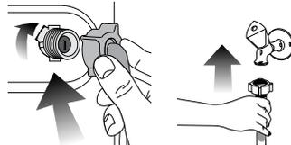
3. После подсоединения шлангов полностью откройте краны для проверки мест подсоединения на наличие протечек. В случае протечки закройте кран и отвинтите гайку. Проверьте прокладку и тщательно затяните гайку еще раз. Во избежание возможных протечек и связанных с этим ущерба закрывайте краны, когда машина не используется.
